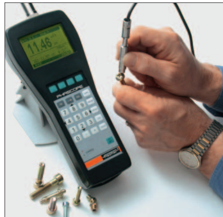
La sonda ESD2.4 e' adatta soprattutto per piccoli pezzi. La calibrazione non e' necessaria al cambio di geometria come nei tradizionali strumenti portatili.
