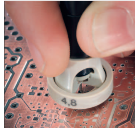
Misurazione della placcatura di rame nei fori attraverso la sonda ESL080V.
